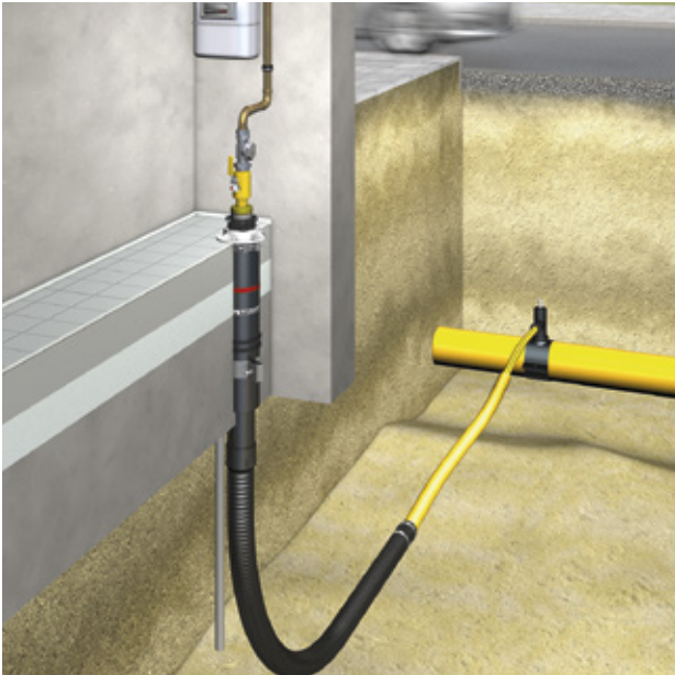
Beispiel ESH (hier Erdgas) für unterkellerte Gebäude
